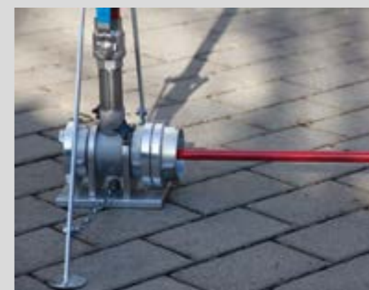
Endstütze verhindert ein Umkippen des letzten Regners in der Reihe
