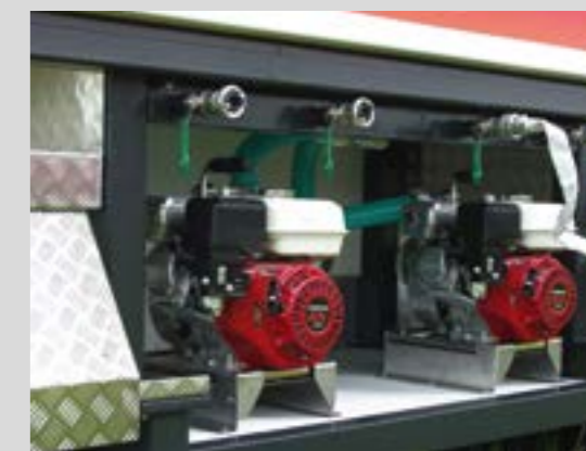
Pumpen- und Stauraum mit 4 D-Anschlüssen
