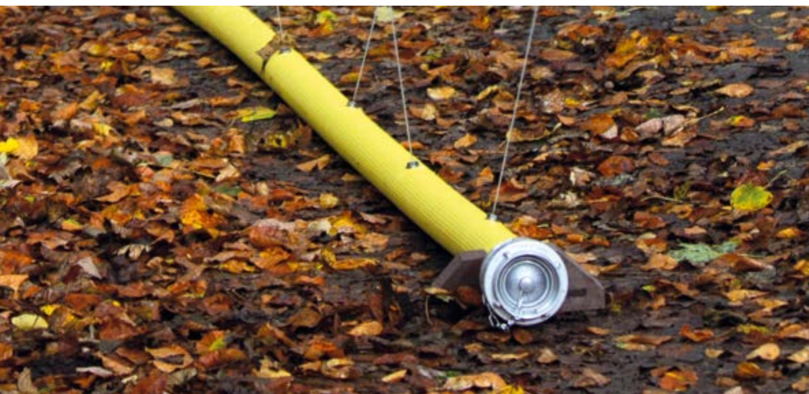
iconos® B-Düsenschlauch mit Waldbranddüsen zur Bildung einer Riegelstellung
